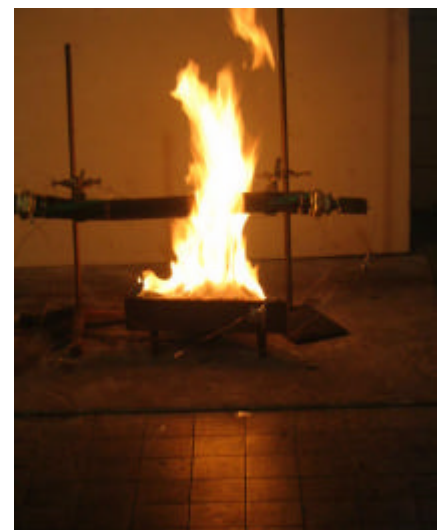
Bremsschlauch während der Prüfung
